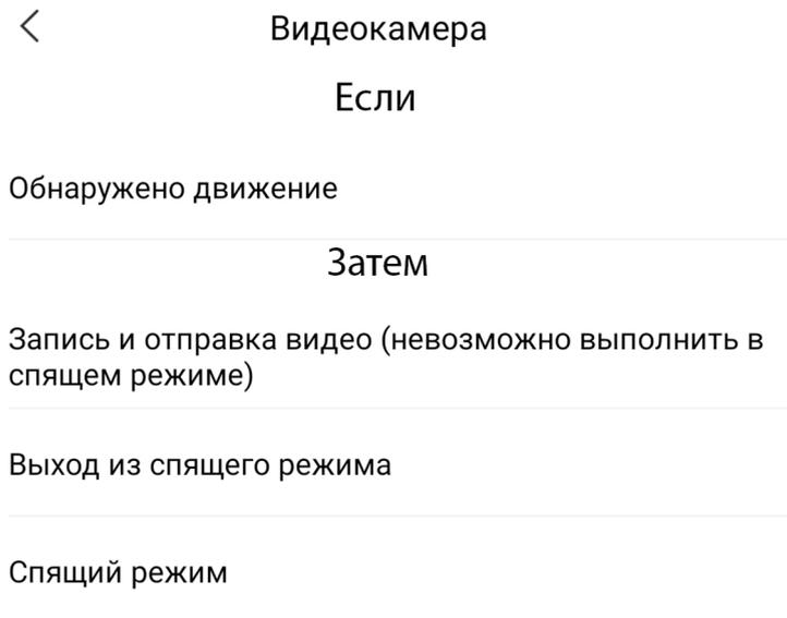
В сценариях камера доступна как условие **"Если"** и имеет один вариант срабатывания - **"Оповещение"**, как условие **"Затем"** - два варианта срабатывания: **"Включить режим сна"** и **"Выключить режим сна"**.
